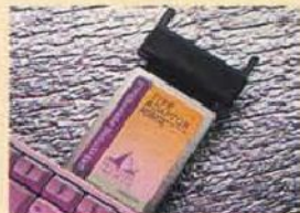
Type I-Type III Adapter Adattatore per utilizzare una card di tipo III anche su personal che dispongono del solo slot di tipo I.
